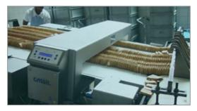
Fig. 3.1.9. Metal detector
